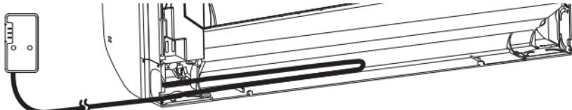
Legen Sie das Anschlusskabel wie in der Abbildung oben gezeigt in den Platz auf der Rückseite des Geräts. Verstauen Sie das Kabel und befestigen Sie es.
