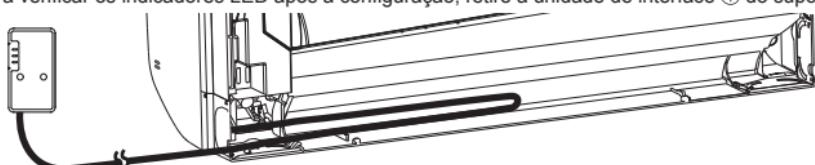
Passe o cabo de ligação no espaço existente na parte posterior da unidade tal como mostrado na figura precedente. Encaminhe o cabo para o ocultar e fixe.
