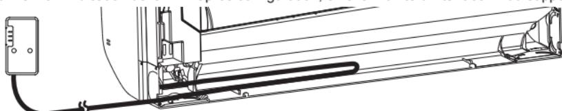
Acheminez le câble de connexion dans l'espace situé à l'arrière de l'appareil comme illustré sur la figure ci-dessus. Rangez bien le câble et fixez-le.
