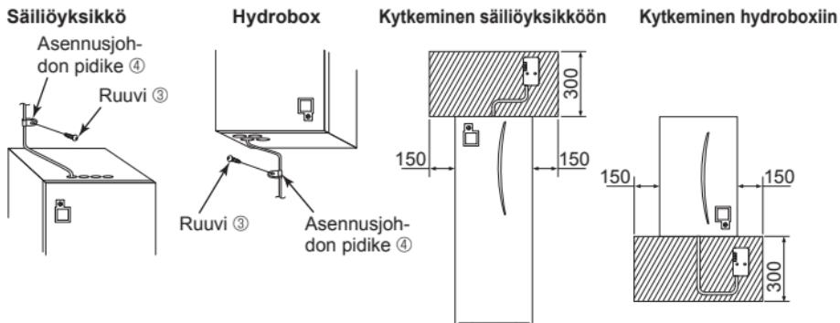
Asennus suoritetaan samalla tavoin kuin asennettaessa ilmastointilaitteeseen. Katso tietoja kohdasta "Asennus seinään" sivulla 6.
