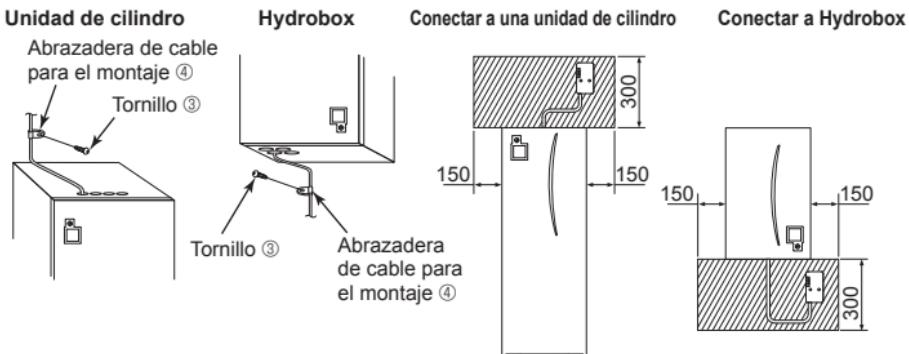
Realice la instalación siguiendo el mismo procedimiento que para el acondicionador de aire de la sala. Consulte la sección "Cuando se instale en la pared" en la página 6.
