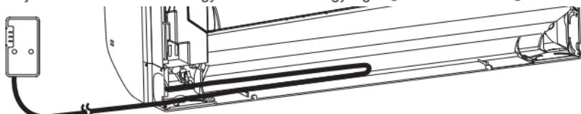
A csatlakozkábelt vezesse az egység hátlóján található helyen, a fenti ábrán látható módon.
