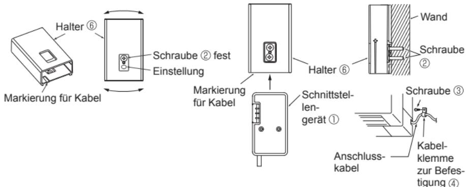
Bei Montage an der Außenseite eines Innengeräts
