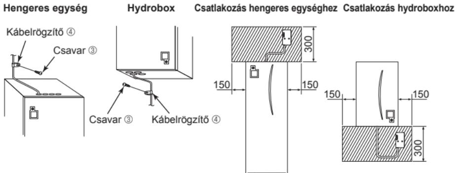
A szobai légkondicionálóval azonos módon szerelje fel. Kérjük, olvassa el a "Falra szerelés" c. részt a 6. oldalon.
